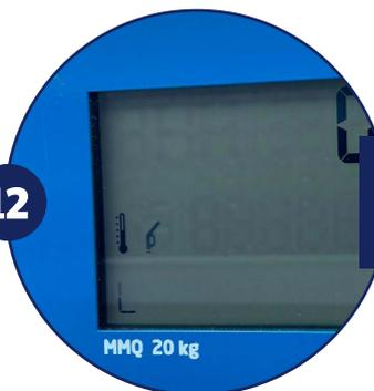
Vengono visualizzate 2 icone (termometro e pistola) per indicare che la fase di rifornimento è iniziata. Il rifornimento inizia quando scompare il termometro.
