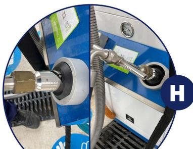
Per riprendere il rifornimento, scollegare la pistola dal serbatoio e appoggiarla sul suo supporto del distributore, ruotandola di 1/4 di giro.
