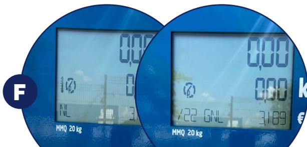
Premere il pulsante "START" per avviare la depressurizzazione. Vengono visualizzate 2 icone (termometro e pistola) per indicare che la fase di depressurizzazione è iniziata. La depressurizzazione inizia quando scompare il termometro.
