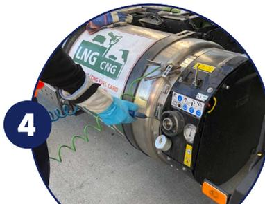
4 Secar y limpiar los 2 orificios del depósito del vehículo (GNL y respiradero) con el soplador de aire comprimido (o con un paño).
