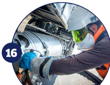
Desconectar la pistola tirando simultáneamente de las 2 empuñaduras hacia atrás. Esperar 3 segundos y luego girar 1/4 de vuelta para desconectarla del vehículo.
