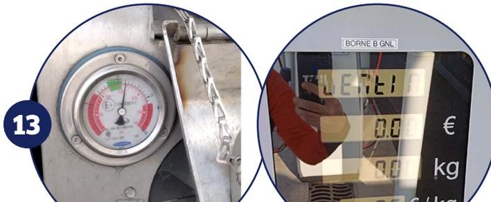
En caso de que sea necesaria una despresurización (presión del depósito superior a 10,5 bares), el surtidor indicará «VENTING». Esperar hasta que el surtidor indique «Presser START» (Pulsar START) y, a continuación, pulsar el botón verde «START».
