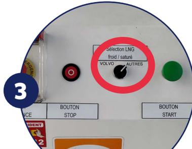
3 Seleccionar el modo de repostaje en función de la marca del vehículo mediante el conmutador situado en el surtidor: «VOLVO/AUTRES» (VOLVO/OTROS).
