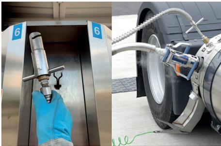
**C** Décrocher le pistolet d'évent de son support de borne et le connecter sur le réservoir véhicule
