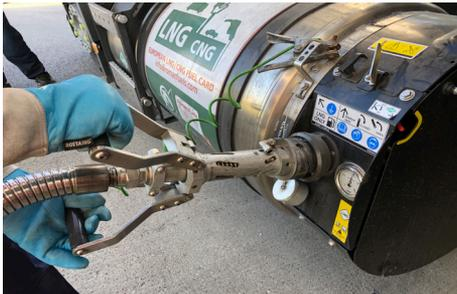
**7** Placer le pistolet d'avitaillement en face de l'embout véhicule aligné avec les ergots
