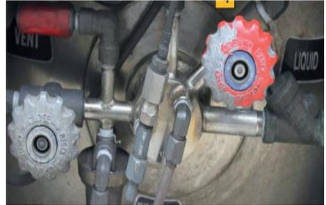
**B** Ouvrir la « vanne grise » d'évent sur chaque réservoir du véhicule
