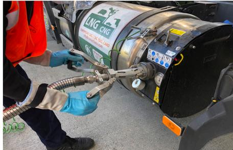
**8** Insérer le pistolet dans le réservoir et réaliser un  $\frac{1}{4}$  de tour pour le verrouiller
