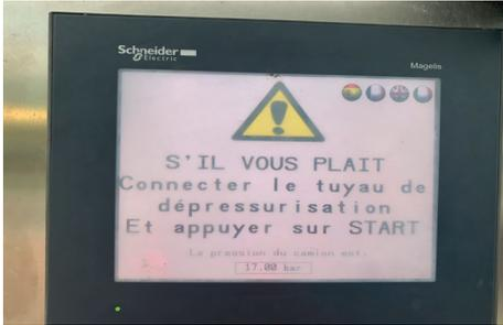
**A** Suivre les instructions indiquées sur l'écran : connecter le tuyau de dépressurisation puis appuyer sur « START »
