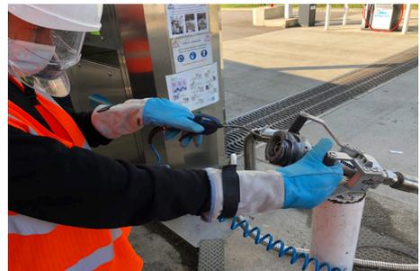
**6** Sécher et nettoyer le pistolet d'avitaillement avec l'air comprimé (ou au chiffon)
