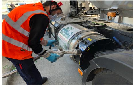
**14** Déconnecter le pistolet en tirant les poignets vers l'arrière, attendre 3 secondes, puis tourner d'un  $\frac{1}{4}$  tour pour le déconnecter du véhicule
