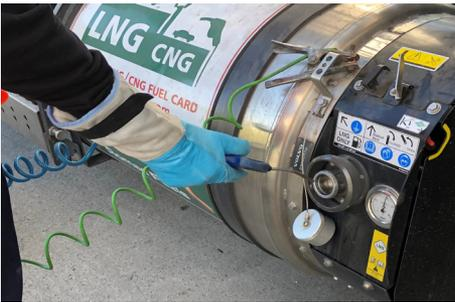
**3** Sécher et nettoyer les 2 embouts réservoir véhicule (GNL et Event) à l'aide de la soufflette d'air comprimé (ou au chiffon)
